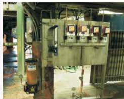
Progresivní centrální mazací systém
