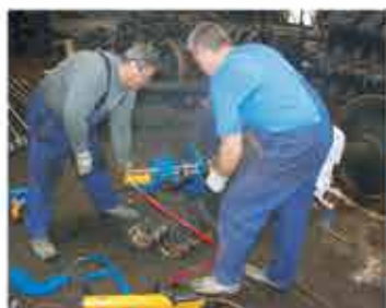
Stahování vnitřních kroužků vagonových ložisek a labyrintů
