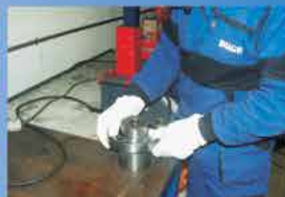
Montáž ložisek pomocí indukčního ohříváče
