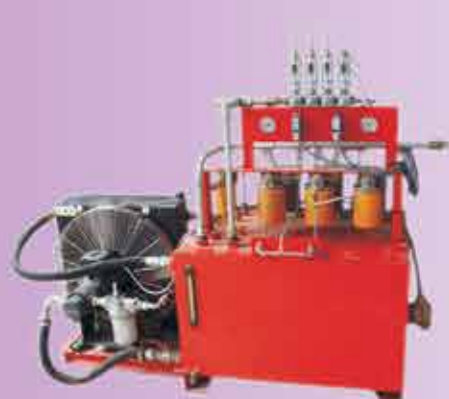
Oběhový olejový centrální mazací systém
