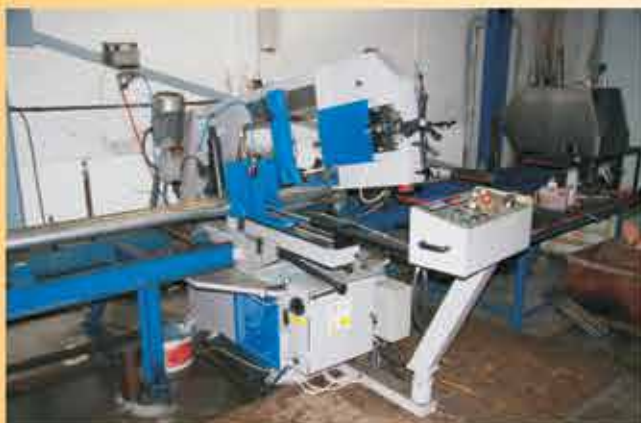
Pásová pila na řezání tyčí a trubek
