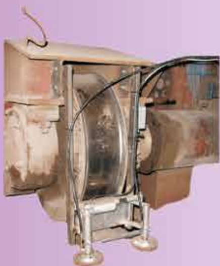
Mazací systém pro mazání jeřábových drah
